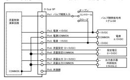
高精度制御を必要とされる場合、電源側では、流量設定COMMON[8]、流量出力COMMON[7]、 電源COMMON[4]を接続しないで下さい。
