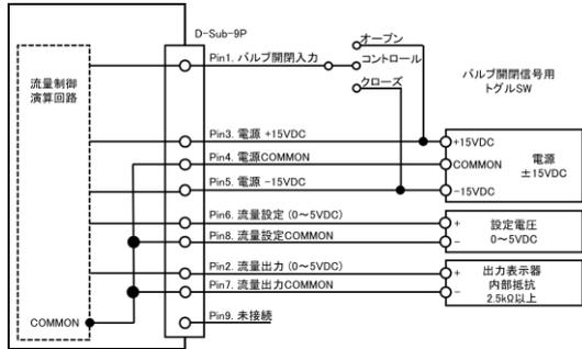
高精度制御を必要とされる場合、電源側では設定電圧COMMON[8]、出力電圧COMMON[7]、電源COMMON[4]を接続しないで下さい。
